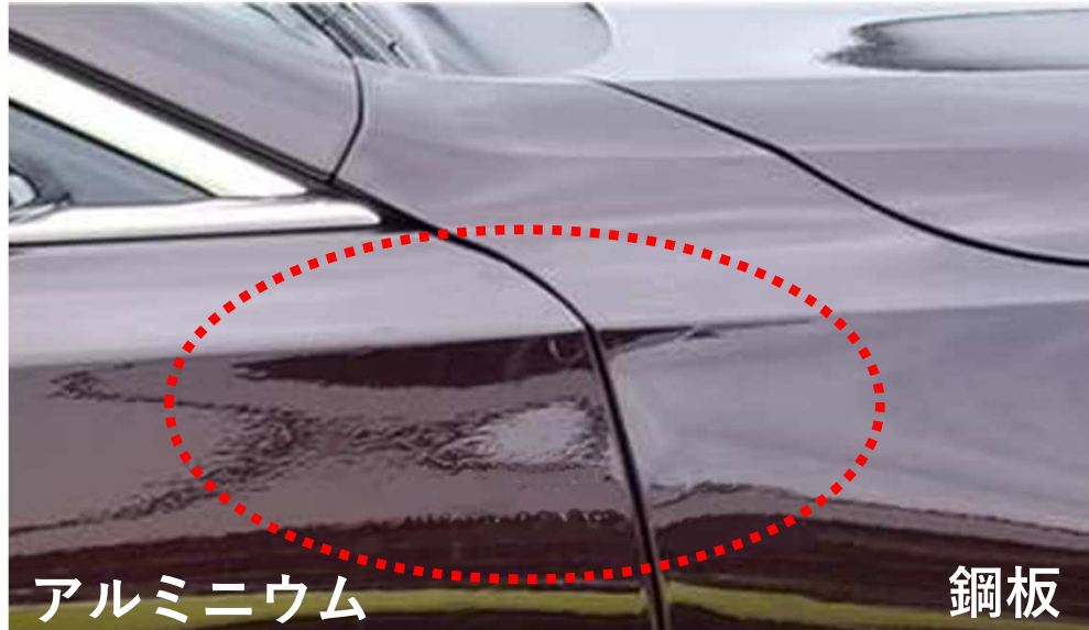
図1. 鉄板の隣にあるアルミ板は、明らかに質感が異なる。 提供：General Motors
