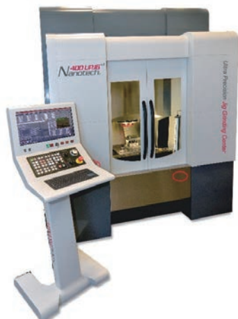
写真1 超精密4軸ジググラインディングセンタ 『ナノテク 400UPJG v1 』
