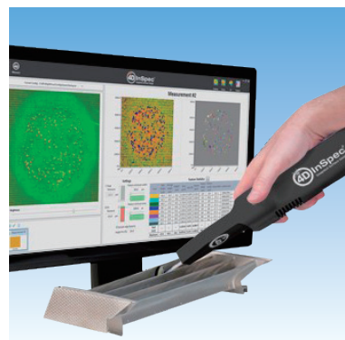
写真6 「4D InSpec サーフェイスゲージ」の測定例
